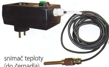
Pri poruche nasávania čerpadla dochádza k zvýšeniu teploty vody v čerpadle až dôjde k poškodeniu a zadretiu čerpadla. Snímač sleduje teplotu vody v čerpadle a pri zvýšení teploty nad nastavenú hodnotu vypína čerpadlo. Snímač sa montuje do vypúšťacieho otvoru samonasávacích čerpadiel namiesto zátky (1/4" alebo 1/8"). Po vypnutí ochrany treba tlačítkom znova spustiť čerpadlo obsluhou. Čerpadlo sa pripoji zasunutím el. prívodného kábla cez integrovanú zásuvku na kryte zariadenia (ochrany)
